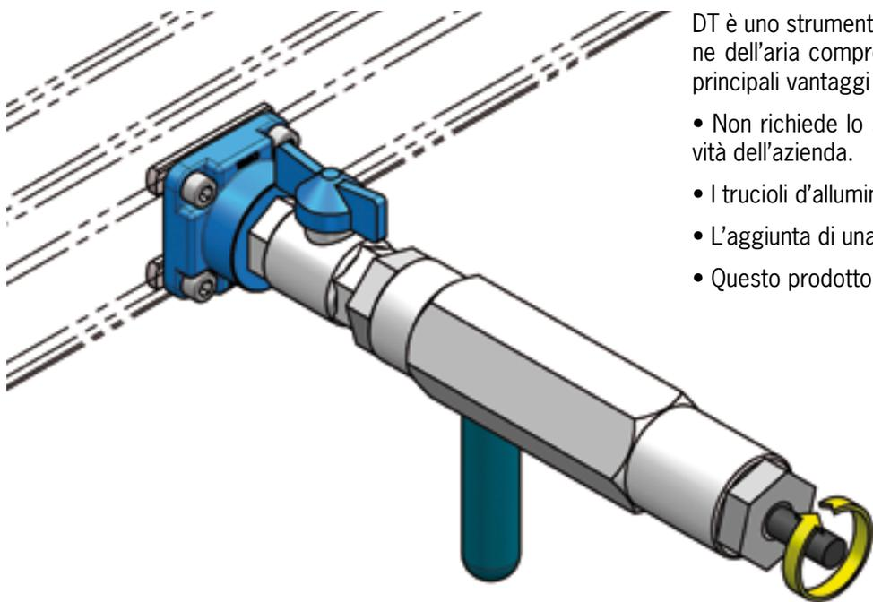
DT è uno strumento che permette di forare la linea di distribuzione dell'aria compressa, in pressione, con facilità e sicurezza. I principali vantaggi dell'impiego di DT:
