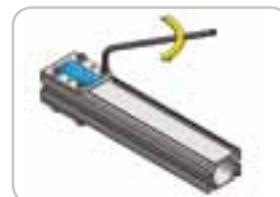
4.3. **Bloccaggio delle viti:** operazione da fare con scrupolo. Le viti vanno strette bene, ma senza esagerare per non strappare il filetto. La coppia di serraggio delle viti M6 è da un minimo di 10 N·m (91 In.Lbs) ad un massimo di 13,5 N·m (120 In.Lbs).
