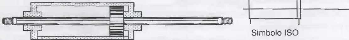
Fig. 6.5 Principio del doppio stelo
