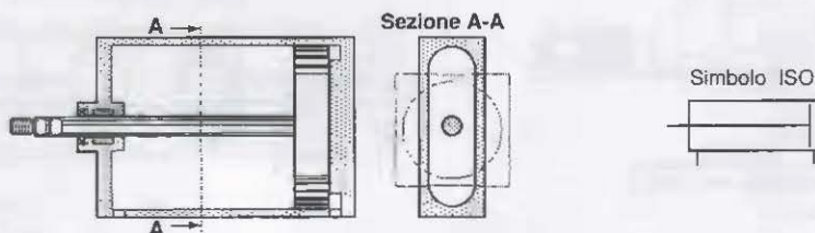
Fig. 6.8 Principio del cilindro piatto
