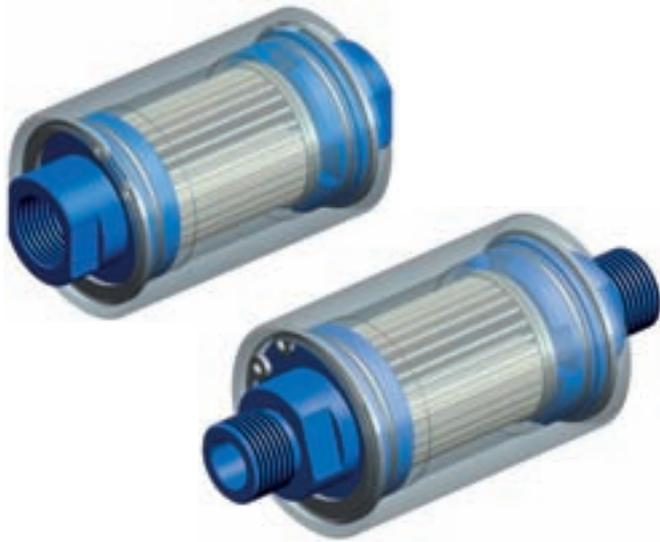
Trattasi di piccoli filtri in linea, in grado di trattenere impurità e polveri finissime, interferendo sulla portata in modo trascurabile. Grazie alle loro ridotte dimensioni, è possibile installarli direttamente sulle tubazioni del vuoto, in prossimità degli utilizzi (ventose, sistemi di staffaggio a depressione e similari), per un filtraggio frazionato e per un maggior controllo visivo di tutti i punti d'aspirazione dell'impianto.
