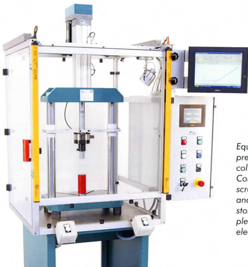
Attrezzatura con servo pressa CP15, forza 15 kN, corsa mm 250 con struttura a colonne e piastra guidastampo. Quadro di comando con pannello operatore touch screen a colori da 5" per impostazione dati e diagnostica. Acquisizione dati e memorizzazione su SD card. L'attrezzatura è completa di protezioni laterali e barriera fotoelettrica frontale di sicurezza.
