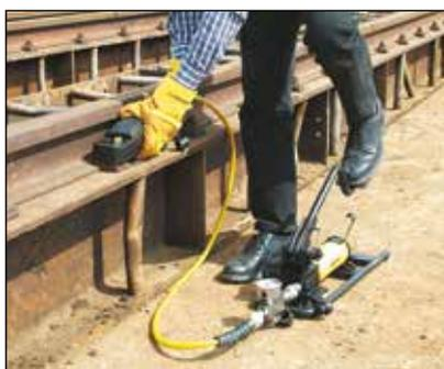
◀ La facile asportazione di dadi arrugginiti durante la costruzione di una ferrovia è solo uno dei molti esempi di applicazione per il tagliadadi Enerpac.
