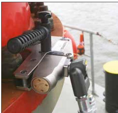
◀ *Riparazione e manutenzione facili e affidabili in officina con chiavi dinamometriche in acciaio Enerpac azionate da una pompa pneumatica.*
