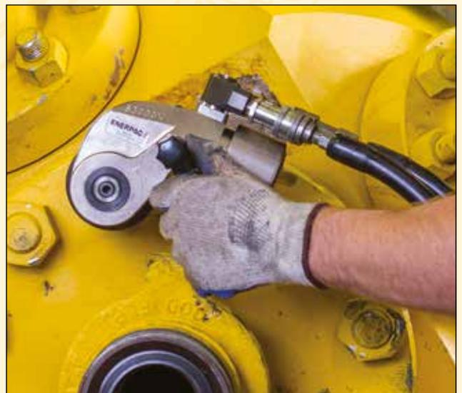
▼ Portainseri W4206X con unità di azionamento W4000X (sul modello posteriore è installata la maniglia dritta opzionale)
