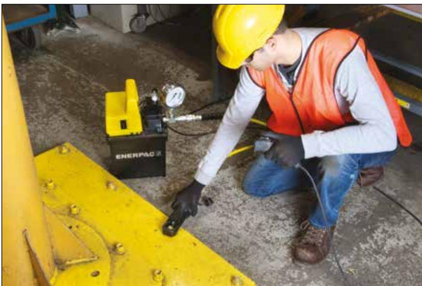
◀ Questa pompa sommersa PED-1101E aziona in modo rapido e silenzioso un tagliadadi idraulico per questa applicazione di manutenzione.
