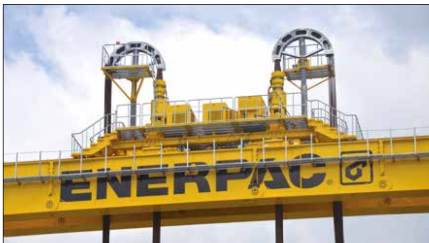
◀ Sistema di martinetti a trefolo HSL85007 utilizzato su una torre automontante Enerpac personalizzata.
