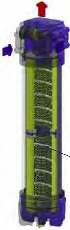
Nei filtri LMP 900 - 901 lunghezza 2, sono installate due cartucce a norma DIN 24550 grandezza 1000 unite tra loro mediante un codolo di congiunzione estraibile.
