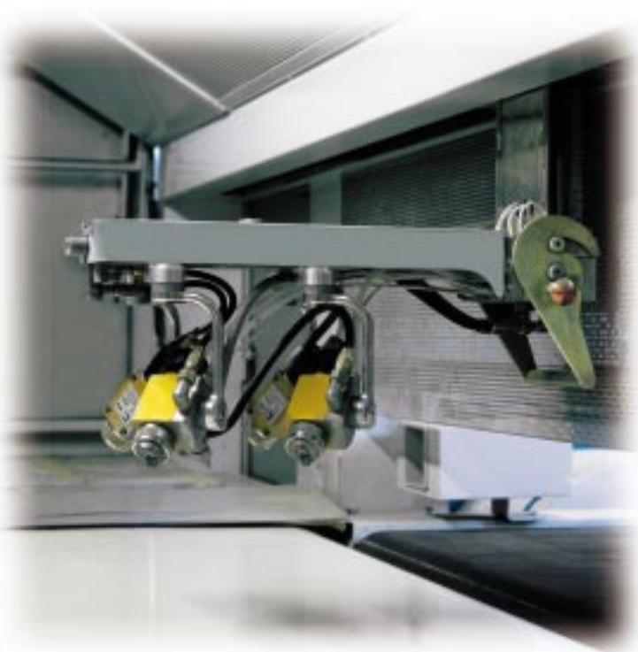
Multiconnessione per impianti robotizzati di verniciatura.
