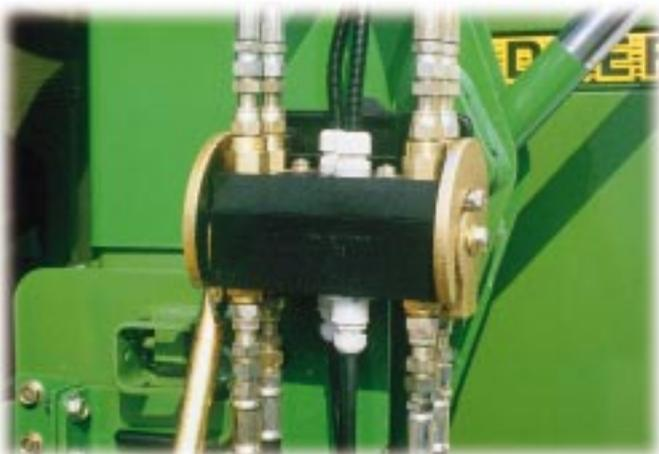
Attacchi rapidi multipli. Collegamento fino a 12 linee idrauliche, elettriche e pneumatiche in una sola operazione senza perdite di olio.
