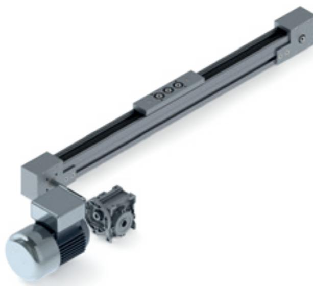
Le unità lineari della famiglia ILM prevedono un accoppiamento tra puleggia motrice e albero di trasmissione tramite chiavetta. L'attacco della motorizzazione può prevedere flange di predisposizione, campane di collegamento, giunti elastici, o, dove possibile, collegamento in diretta tra motore/riduttore e puleggia motrice. Predisposizioni attacco motore/riduttore sono personalizzate secondo le esigenze dei clienti.
