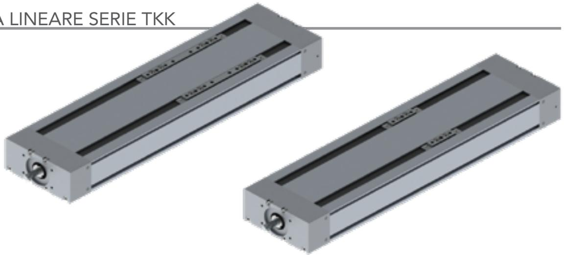
La famiglia TKK è stata progettata ricercando elevata precisione, elevata rigidezza, dimensioni ridotte, semplicità costruttiva e facilità di montaggio. Gli assi sono costituiti da una struttura autoportante in alluminio anodizzato sui cui vengono fissate due guide lineari a ricircolo di sfere. Il comparto di trasmissione è affidato a viti a ricircolo di sfere o trapezie e relative chiocciolate.
