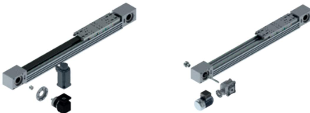
Le unità lineari della famiglia TLY prevedono un accoppiamento tra puleggia motrice e albero di trasmissione tramite calettatore. L'attacco della motorizzazione può prevedere flange di predisposizione, campane di collegamento, giunti elastici, o, dove possibile, collegamento in diretta tra motore/riduttore e puleggia motrice. Predisposizioni attacco motore/riduttore sono personalizzate secondo le esigenze dei clienti.
