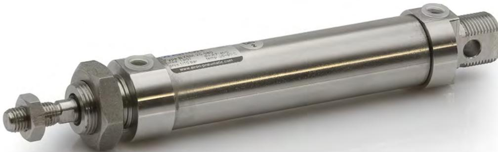
I cilindri pneumatici serie "XB" sono attuatori realizzati completamente in acciaio inox AISI 304 o 316 seguendo le specifiche dimensionali contenute nella norma ISO 6432 che le definisce per gli alesaggi da 12 a 25 mm.
