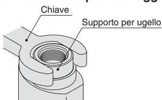
Limiti della coppia di serraggio dell'ugello da 12 a 14 N·m
