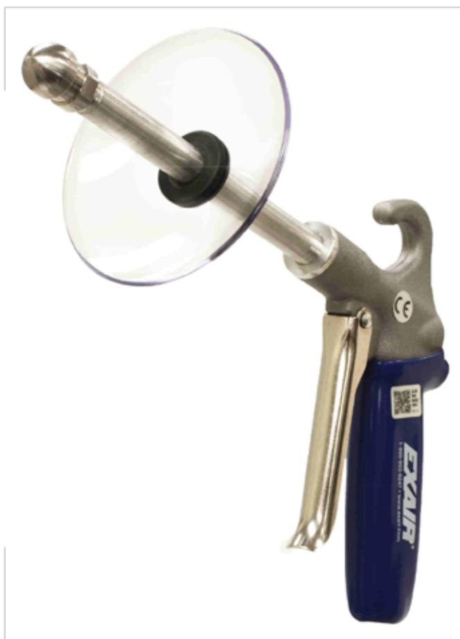
Pistola Super Blast Safety Air Gun 1206SS-6-CS per la pulizia interna di tubi o profilati scatorati (con ugello 1008SS inox AISI 316, prolunga 30,5 cm, schermo di protezione in policarbonato)
