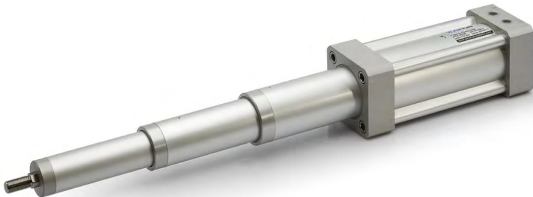
I cilindri telescopici della serie "TL" sono degli attuatori lineari che effettuano una corsa maggiore dell'ingombro del cilindro interamente chiuso. Il concetto costruttivo di tali cilindri è quello di inserire più cilindri in uno, pertanto la scelta viene effettuata in funzione della forza di spinta dell'ultimo sfilamento (l'alesaggio dello sfilo più piccolo).
