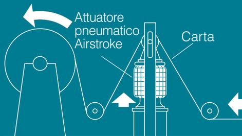
**DISPOSITIVO DI TENSIONAMENTO WEB**
