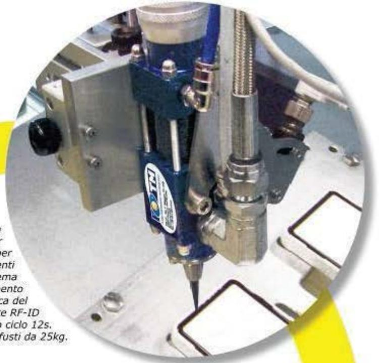
*Sistema di dosaggio volumetrico continuo per silicone monocomponente per la sigillatura di componenti automotive, integrato su sistema cartesiano a 3 assi. Riconoscimento formato e selezione automatica del programma di dosaggio tramite RF-ID sul vassoio porta-pezzi. Tempo ciclo 12s. Cordolo di 1,5mm. Prodotto in fusti da 25kg.*
