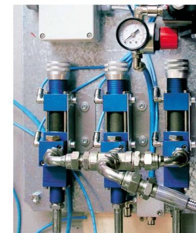
Dosatori volumetrici mod. VVAPDV accessoriati con sensori di flusso mod. VSF per il dosaggio di pasta siliconica su una linea di montaggio settore automotive.
