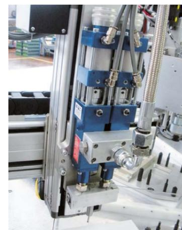
Coppia di dosatori volumetrici mod. VVAPDV integrati in un sistema pneumatico bicilindrico a frequenza per l'erogazione di cordoli di silicone volumetrici continui, per la sigillatura di coperchi nel settore automotive.
