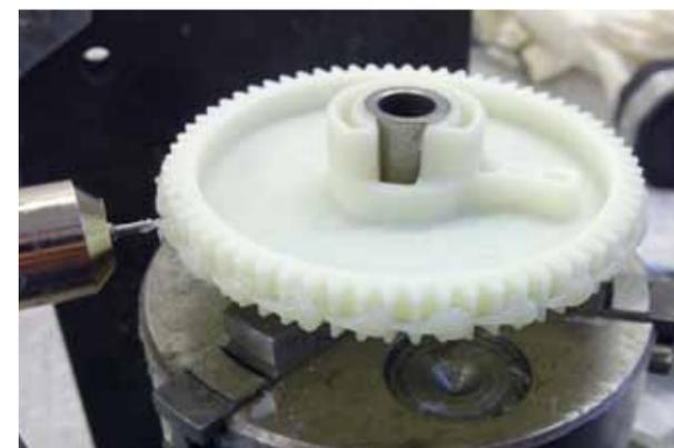
Esempio di dosaggio di grasso siliconico sui denti di un ingranaggio. Dose di circa 1,5g erogata lungo la circonferenza in 3s.
