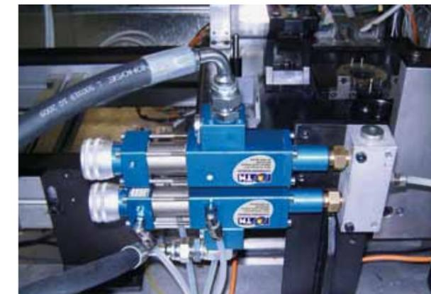
Installazione di valvole erogatrici VAPDV su linea automatica per dosaggio di grasso. Applicazione particolare con due valvole confluenti su un collettore unico. Alimentazione ad alta pressione da una pompa di estrusione PE200W301 per fusti da 200kg.
