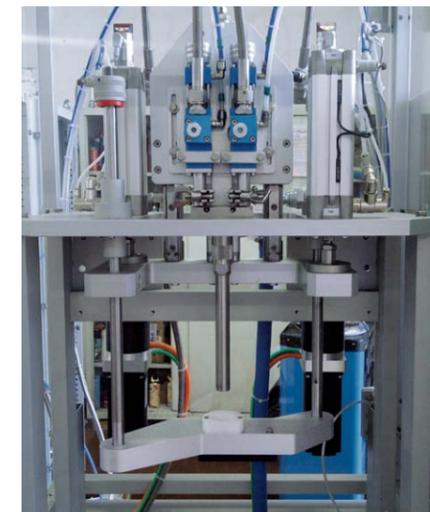
Esempio di valvole VAP installate su impianto bicomponente volumetrico.
