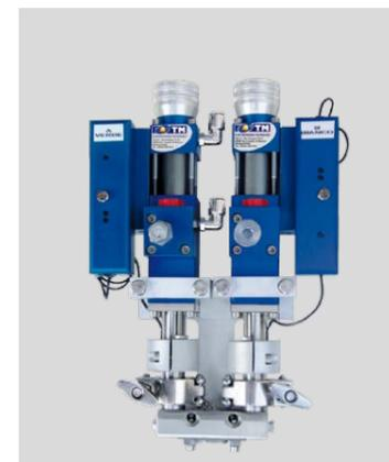
Esempio di testa bicomponente con coppia di valvole VAP su collettore con soluzione speciale a CLAMP per smontaggio rapido e pulizia dell'impianto. Notare anche la presenza dei sensori di flusso VSF-PZ integrati sulla testa delle valvole VAP per rilevare i dosaggi ad ogni ciclo di erogazione.
