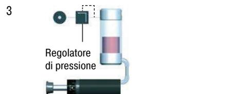
La forza di riarmo può essere modulata tramite il regolatore di pressione. Assicurare una pressione minima per il riarmo del deceleratore in tutta sicurezza.
