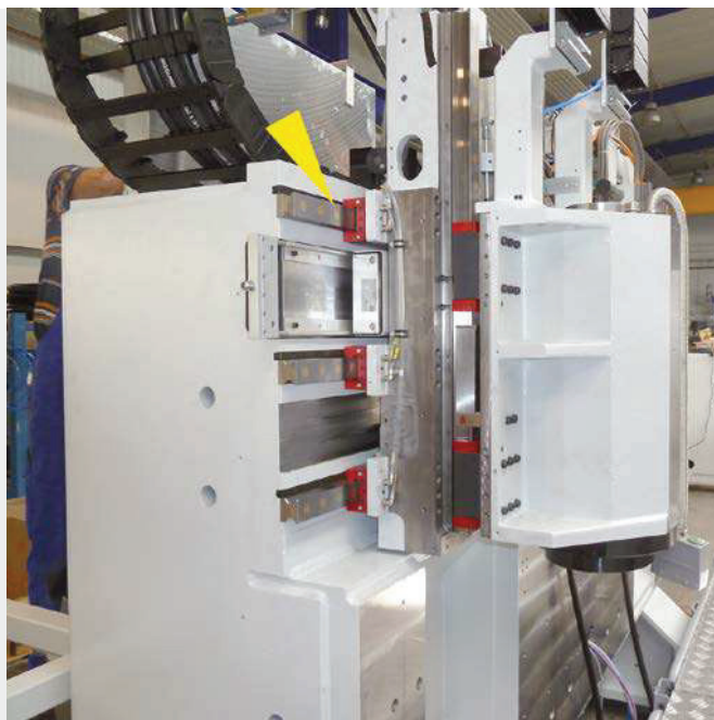
Gli elementi di bloccaggio e sicurezza ACE mantengono una presa altamente solida sugli assi dei torni speciali, e garantiscono le posizioni prestabilite sia nella direzione orizzontale che verticale RASOMA Werkzeugmaschinen GmbH, 04720 Döbeln, Germania
