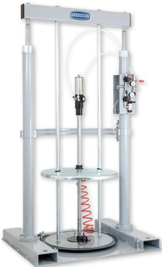
Attrezzatura per ingrassaggio con sistema sollevamento pompa e premigrasso forzato tramite circuito pneumatico, attivabile tramite valvola di comando.
