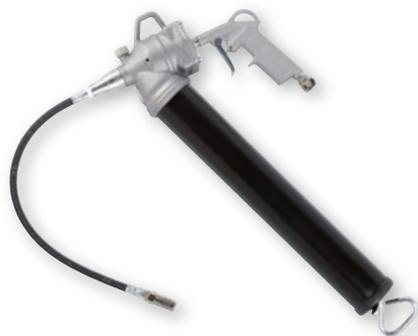
Compressore pneumatico per cartucce o grasso sfuso, completo di tubetto flessibile M10x1 lunghezza 300 mm e testina Hydraulic 4 griffe. Il funzionamento della pistola è a semplice effetto (erogazione discontinua): agendo sulla leva di comando il pistone all'interno della testata avanza e spinge il grasso, rilasciando la leva il pistone arretra portandosi in posizione iniziale. Ripetendo queste operazioni si ha la fuoriuscita del grasso. Pressione di alimentazione aria: da 4 a 8 bar.
