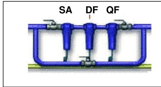
PROTEZIONE STRUMENTAZIONE PNEUMATICA
