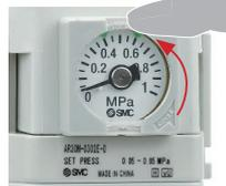
Chiudere il coperchio del manometro nella direzione della freccia e premerlo finché non scatta in posizione.
