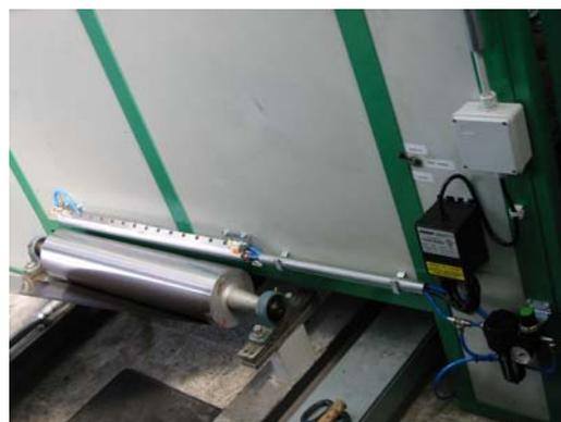
Standard Ion Air Knife 7136 neutralizza cariche e pulisce un film di lamiera metallica prima della verniciatura
