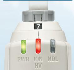
Si accende quando viene rilevata una riduzione del livello di neutralizzazione statica a causa di contaminazione, usura o rottura dell'elettrodo.
