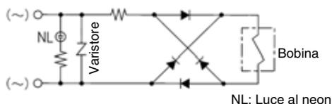
Nota) Il soppressore di picchi del varistore presenta una tensione residuale corrispondente all'elemento protettivo e alla tensione nominale; proteggere pertanto il lato del controllore da picchi di tensione. Inoltre, la tensione residua del diodo è di circa 1 V.
