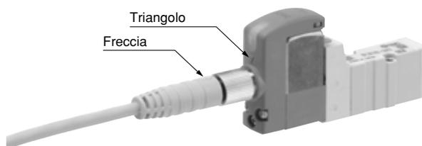
Nota) Il cavo del connettore va montato nella direzione corretta. Assicurarsi che il simbolo della freccia sul connettore sia rivolto verso il simbolo del triangolo sulla valvola se si utilizza il cavo connettore SMC (V100-49-1-□). Prestare attenzione a non schiacciarlo nella direzione sbagliata poiché si potrebbe danneggiare il terminale.
