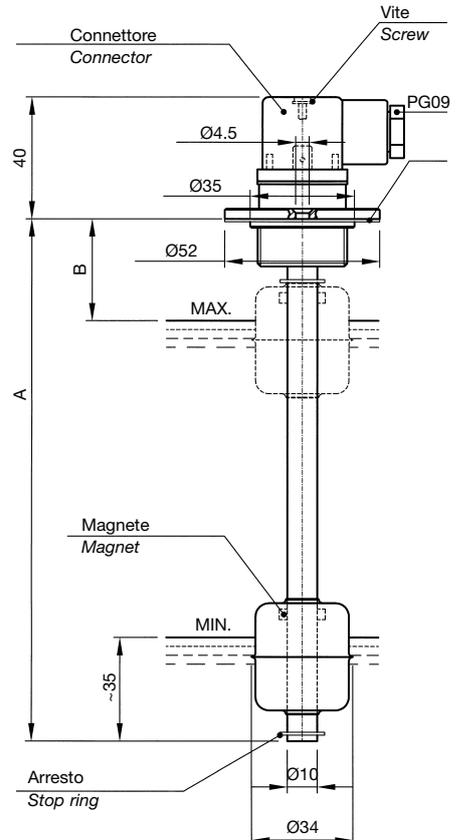
**MATERIALE:** flangia, tubo, anelli di arresto e galleggiante in acciaio inox.
