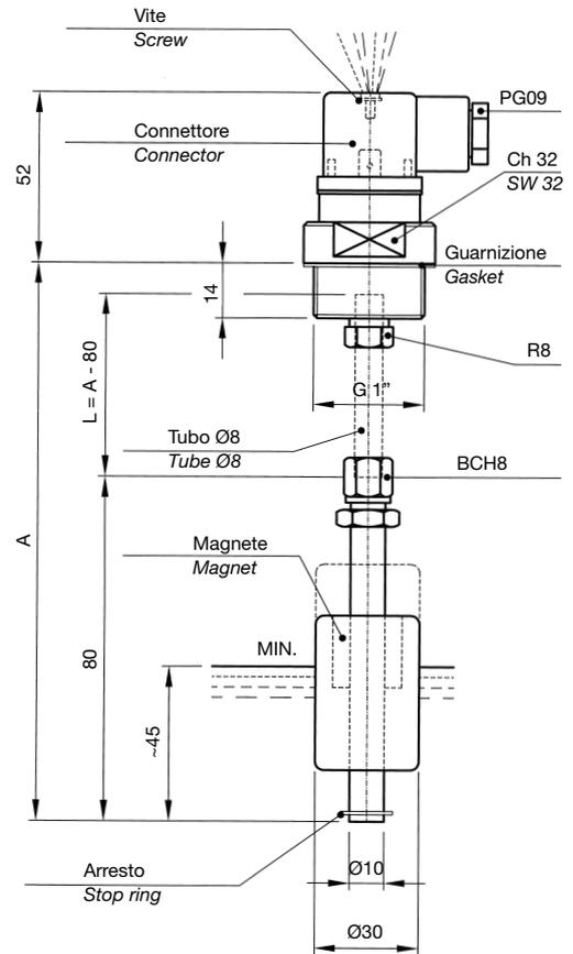
**MATERIALI:** flangia filettata G1" in alluminio anodizzato, raccordo R8 in ottone nichelato, bicono B8 e bocchettone BCH8 in ottone, anello di serraggio ANS8 in ottone; corpo di ottone; galleggiante NBR.
