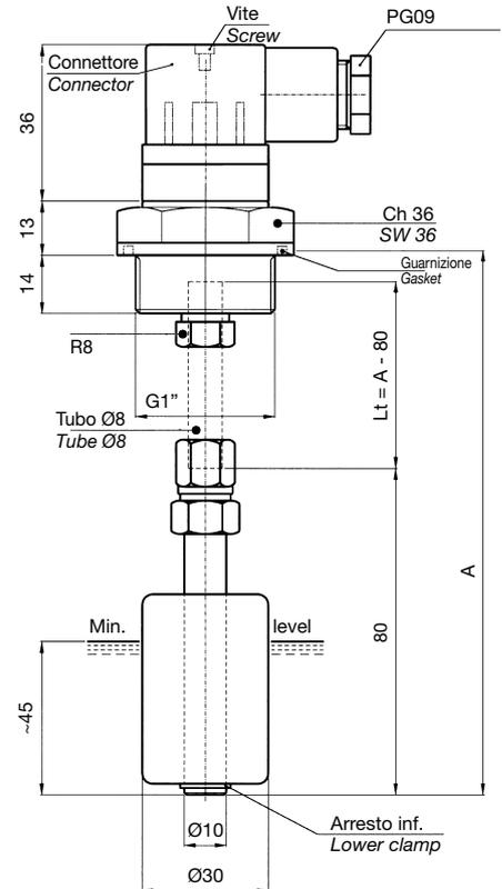
**MATERIALI:** flangia in termoplastico, corpo in ottone, bocchettone BCH8 e anello di serraggio ANS8 in ottone, galleggiante in resina espansa NBR.
