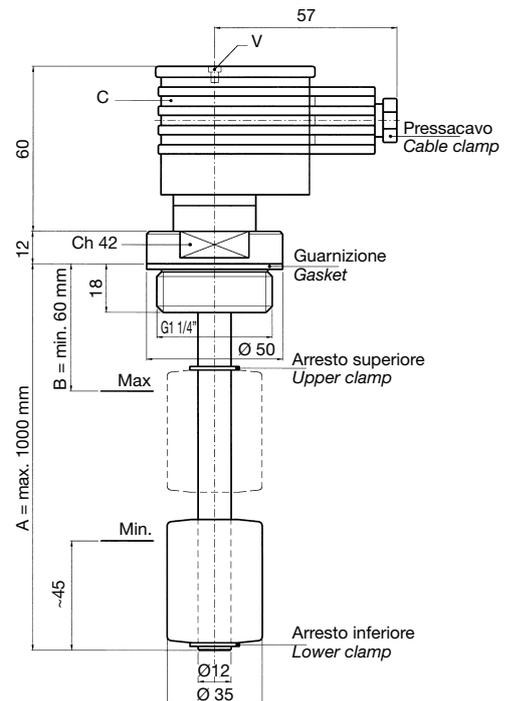
Le sonde di livello SLM1FA...CVS1, SLM2FA...CVS1 e SLM1TA...CVS1, SLM2TA...CVS1 con convertitore di segnale 4/20 mA alloggiato nel connettore C, sono state concepite per controllare in continuo il livello di un liquido contenuto in un serbatoio di stoccaggio.
