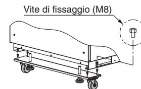
Fig. 3 Vite di fissaggio (8 pz.)
