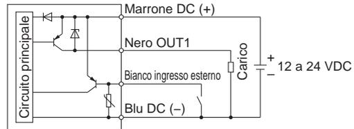
**Esempi di cablaggio per uscita a impulsi integrati**
