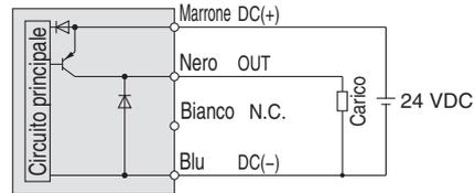
Max. corrente di carico 80 mA; caduta interna di tensione: 1.5 V max.
