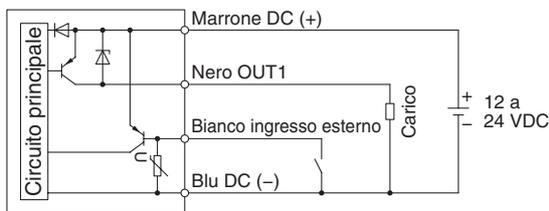
Max. corrente di carico: 80 mA, caduta di tensione interna: 1.5 V max.
