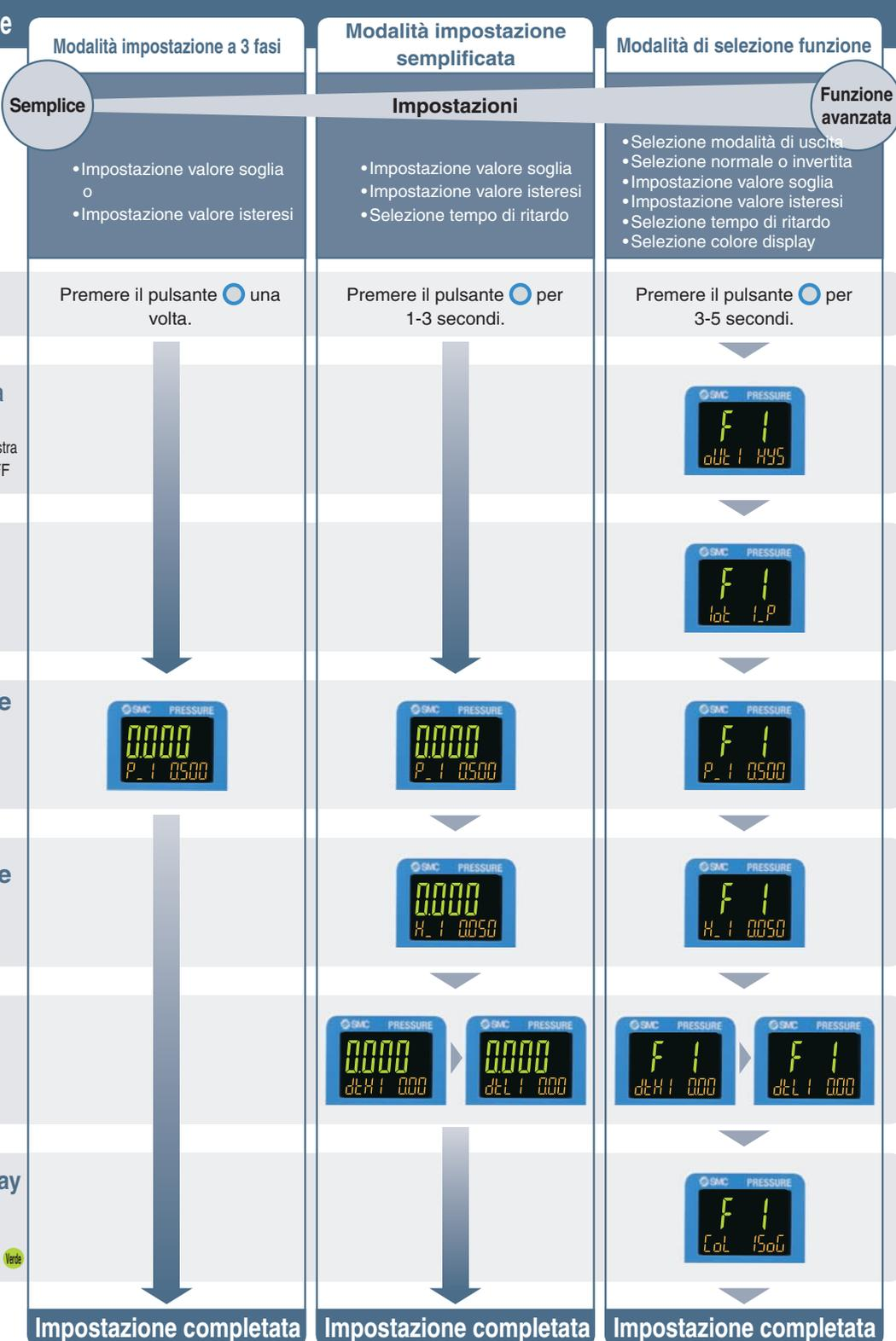
\* Il grafico sopra mostra il funzionamento di OUT1. La modalità di selezione delle funzioni per OUT2 viene impostata con "F2". Nell'illustrazione qui sopra viene visualizzato "2" invece di "1". (Esempio) P\_1 → P\_2
