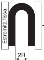
Piegare il tubo nella forma a U ad una temperatura di 20°C. Fissare un'estremità e chiudere gradualmente. Misurare 2R quando la deformazione percentuale del diametro del tubo nella curvatura raggiunge il 5%.
