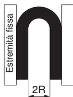
Piegare il tubo nella forma a U a una temperatura di 20°C. Fissare un'estremità e chiudere gradualmente. Misurare 2R quando la deformazione percentuale del diametro del tubo nella curvatura raggiunge il 5%.
