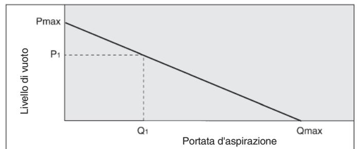
Per portata si intende il livello di vuoto dell'eiettore e la portata d'aspirazione. Sono relazionate, pertanto se cambia l'indice di portata d'aspirazione, cambierà anche il livello di vuoto. Normalmente questa relazione si manifesta nell'uso standard dell'eiettore. Nel grafico, Pmax indica il livello di vuoto massimo e Qmax indica la portata di aspirazione massima. I valori sono specificati in base all'uso normale. Nell'ordine in basso sono indicate le variazioni del livello di vuoto.
